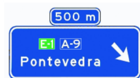
S-232 Preseñalización con señales sobre la calzada en carretera convencional hacia autopista o autovía
