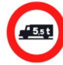
R-107 Entrada prohibida a vehículos destinados al transporte de mercancías con mayor masa autorizada que la indicada
