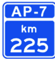
S-570a Hito kilométrico en autopista de peaje
