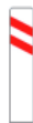
P-10b Aproximación a un paso a nivel, puente móvil o muelle (lado izquierdo)
